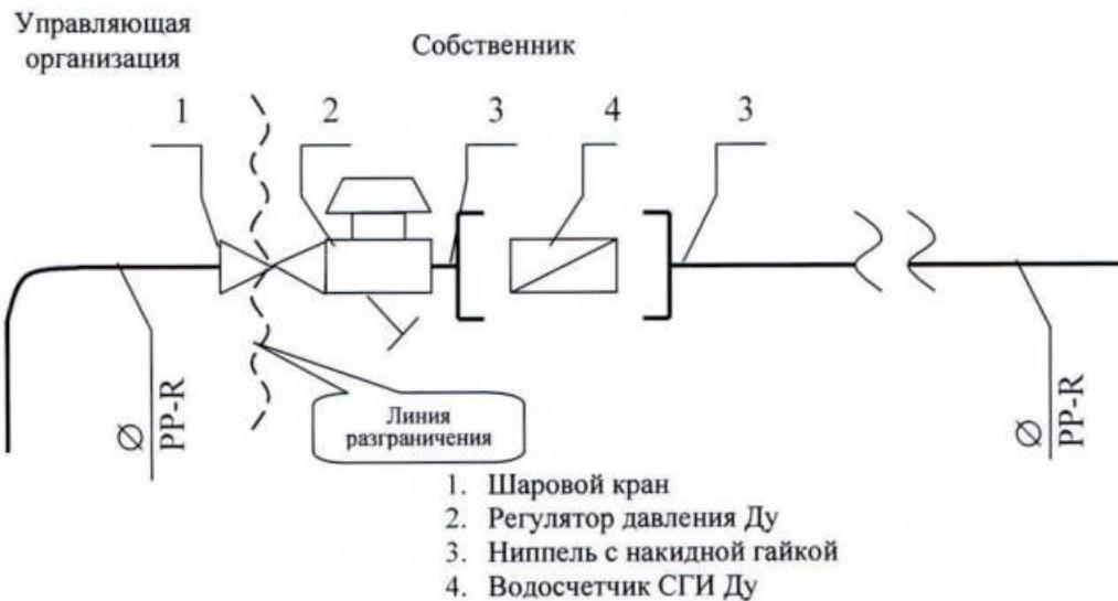
Исполнитель несет ответственность за надлежащее состояние и работоспособность систем горячего и холодного водоснабжения согласно нижеуказанной схеме до волнистой линии слева (включая шаровой кран).
